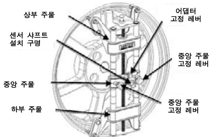
만일 분리했으면, 센서 설치 샤프트를 (센서의 뒤쪽에서) 중앙 주물 중앙에 있는 센서 설치 구멍 속에 끼워 센서를 휠 어댑터에 부착하십시오.
