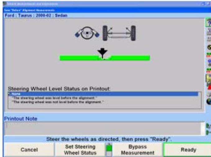
만일 "얼라이너 설정"에서 "측정값이 저장될 때 스티어링휠 상태 설정"이 기능정지되었고 모든 측정값들이 안정되어 있고 차가 똑바로 앞으로 조향 되어 있으면, "작업전 얼라인먼트 측정값 저장" 팝업 스크린이 계속 진행하게 됩니다. 스크린이 잠시 나타나고 모든 것이 안정되었으면 설정이 자동적으로 저장되게 됩니다.
