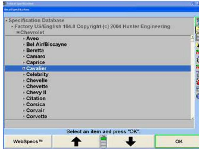
다시 " ↑ "나 " ↓ "를 눌러 해당 차량을 하이라이트 시키십시오. "확인"을 누르십시오. 차량이 완전히 확인될 때까지 이러한 방법을 계속하십시오. 해당 차량이 확인 되었을 때, 해당 규격을 불러오고 스크린은 "차량 규격" 기본 스크린으로 바뀌게 됩니다.
