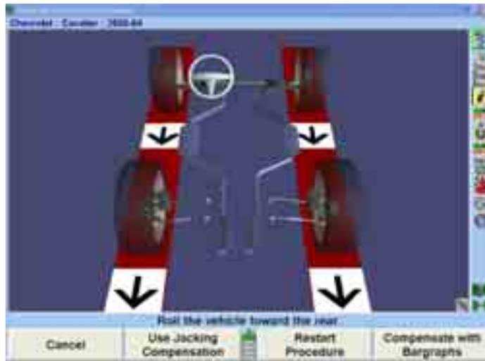
**참고:** 28 인치 직경의 타이어를 끼는 차량을 대략 30-40 cm 이동할 필요가 있습니다. 더 적은 직경의 타이어는 더 적게 움직여도 되고, 반면에 더 큰 직경의 타이어는 더 많이 움직일 필요가 있습니다.
