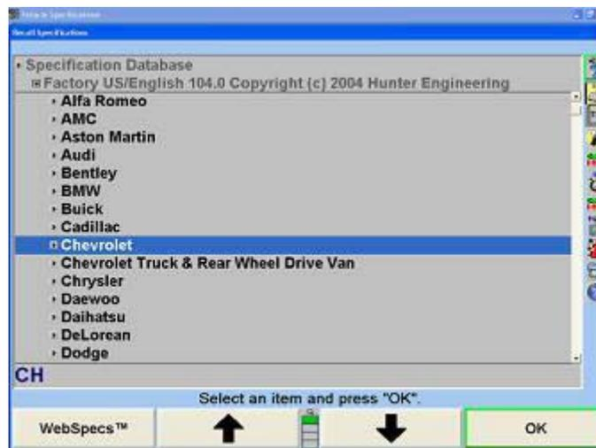
규격은 원 장비 제조회사 규격, "공장 정정 규격" 또는 "사용자 규격"에 근거한 "제조회사 규격"에서 불러올 수 있습니다. "공장 정정 규격" 및 "사용자 규격"은 장비 사용자가 작성해서 컴퓨터 메모리에 저장할 수 있습니다.
