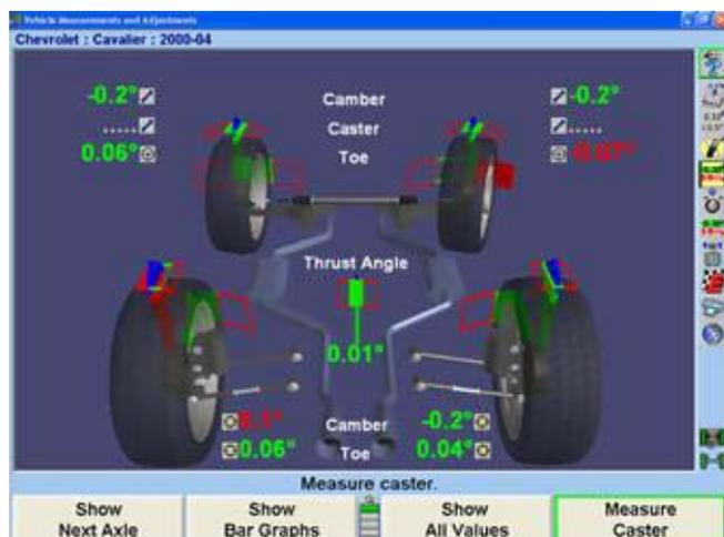
절차 막대에서 "캐스터 측정" 아이콘을 누르십시오. 스크린은 "캐스터 및 S.A.I. 측정" 팝업 스크린으로 바뀌게 되고 이 스크린에서 당신이 캐스터를 측정하도록 지시하게 됩니다.
