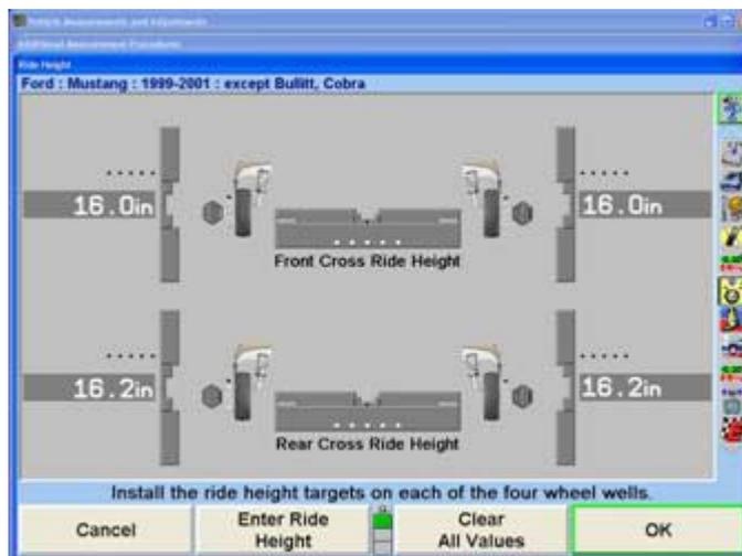
만일 “실시간 승차높이” 스크린이 얼라인먼트 작업 절차의 일부로서 자동적으로 나타나지 않으면, “차량 측정 및 조정” 스크린에서 “추가 측정”을 선택하십시오.
